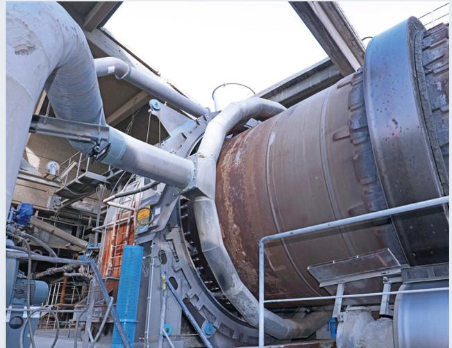
Graphitblockdichtung am Drehofen an der Auslaufseite.
