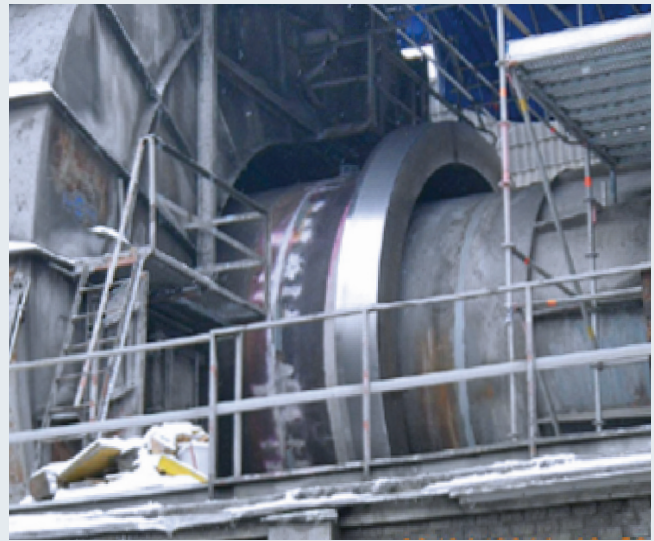
Station IV eines Drehofens mit Planetenkühler
