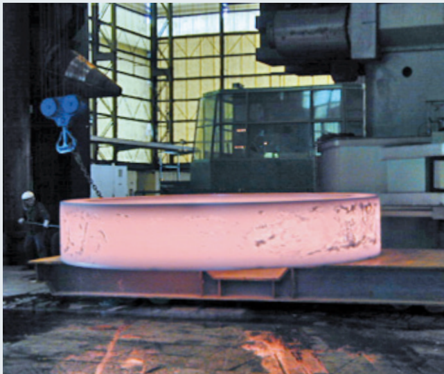
Geschmiedeter Laufring bei der Herstellung
