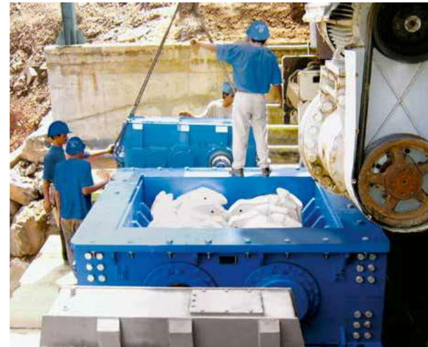
RollSizer DRS 800 x 1500 CenterSizer für die Primärzerkleinerung von Silikatgestein. Durchsatzleistung: 700 t/h.
