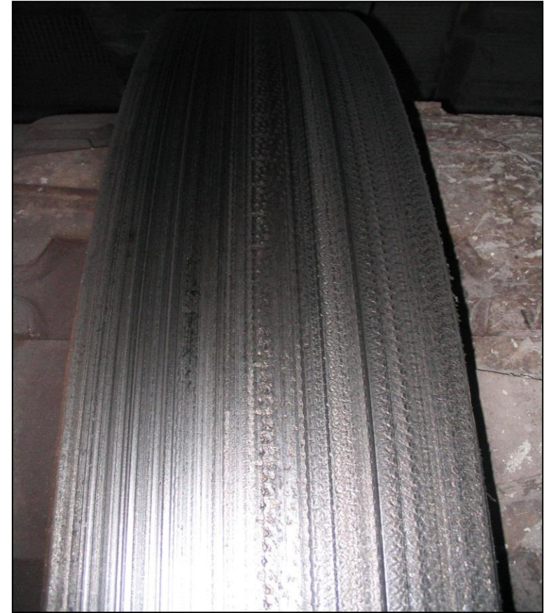
Riefen und Radierungen in Umfangsrichtung auf Laufrolle und Laufring
