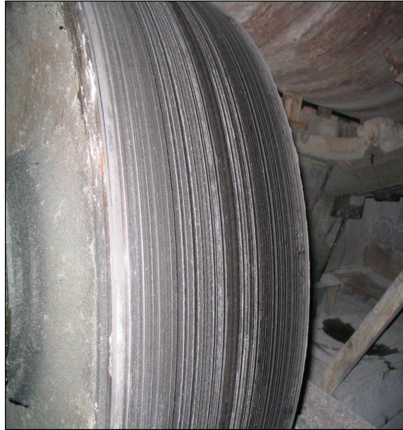
Riefen und Radierungen in Umfangsrichtung auf Laufrolle und Laufring
