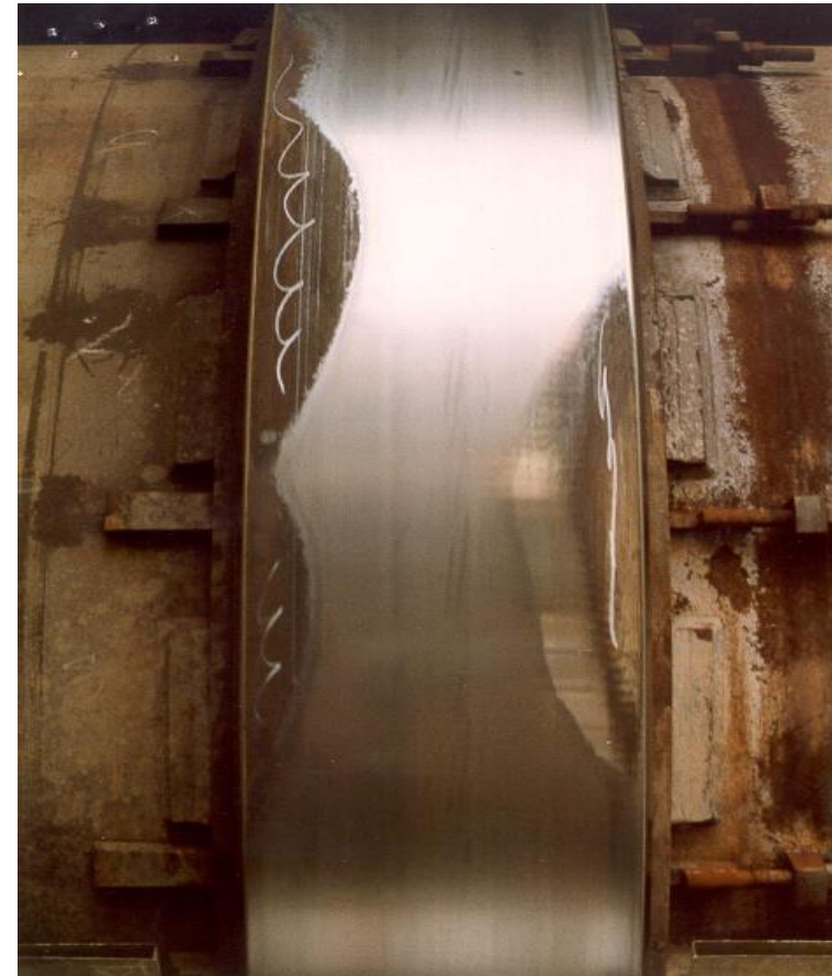
Laufring: Konvexe Kontur, Foto während der Bearbeitung
