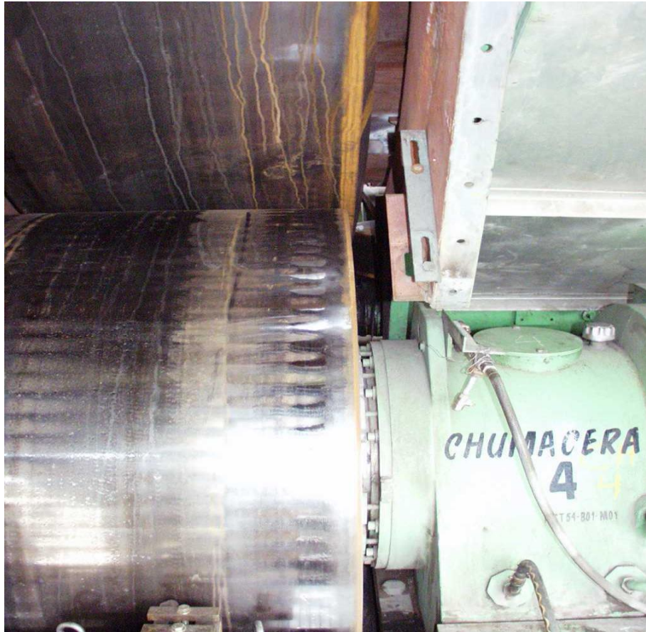
Laufrolle: Riffelbildung quer zur Drehrichtung aufgrund von Antriebsschwingungen
