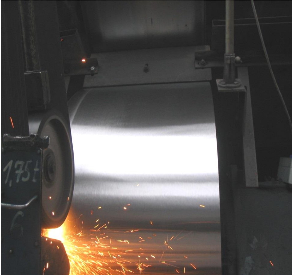
Laufrolle kurz vor Beenden der Schleifarbeiten
