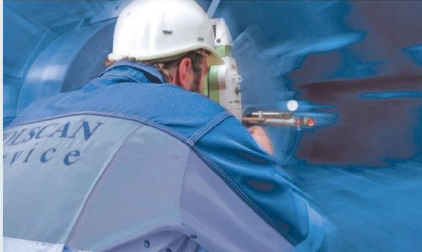
polscan® - Hochpräzises optoelektronisches Messsystem im Einsatz vor Ort
