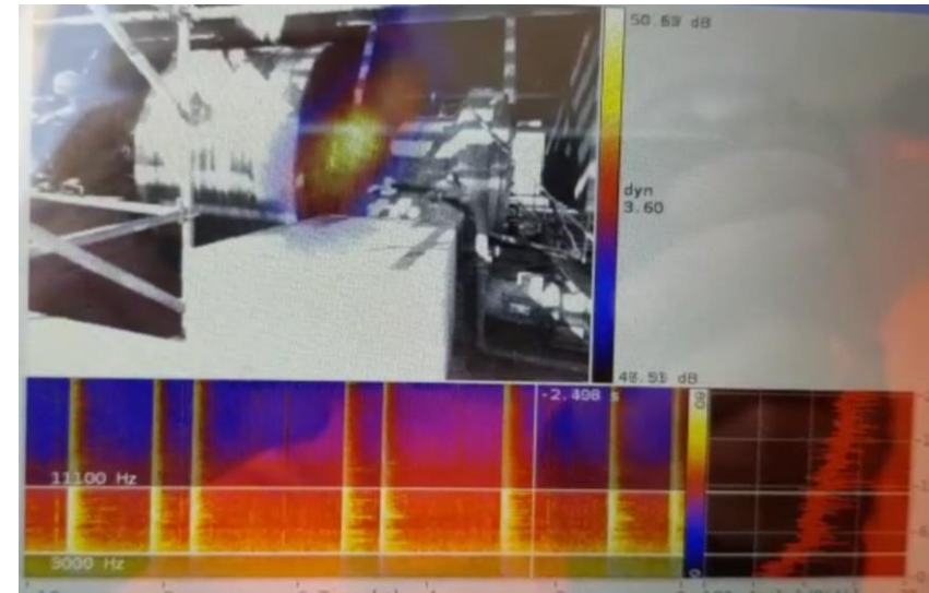
Beispiel: Geräusch an einer Ofenlaufrolle verursacht durch das Anschlagen des Ölschöpfers
