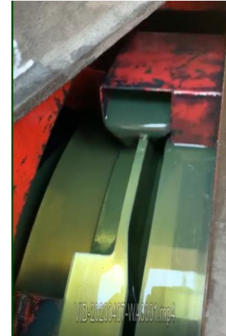
Beispiel: Geräusch an einer Ofenlaufrolle verursacht durch das Anschlagen des Ölschöpfers
