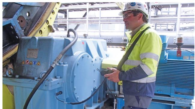
Schwingungsmessungen an einem Stirnradgetriebe
