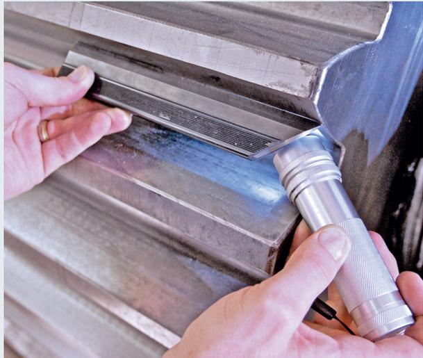
Verschleißprüfung an der Lastflanke einer Großverzahnung
