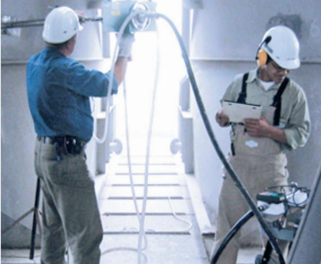
Staubmessung im Vorwärmer
