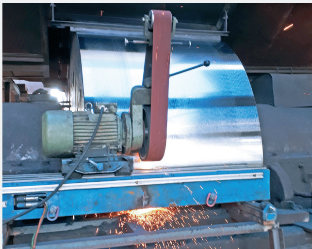
Schleifarbeiten am Lauftring und einer Laufrolle
