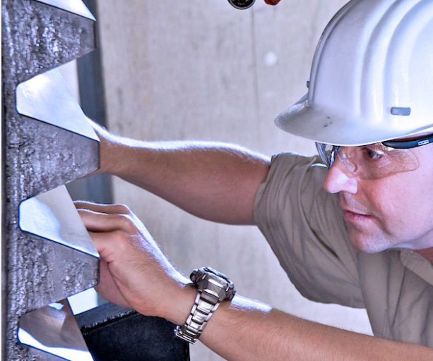
Prüfung des „statischen Tragbildes“ einer Großverzahnung
