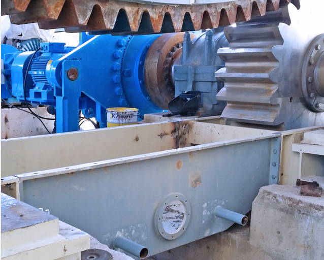
Montage der Ölwanne eines Doppelritzelantriebes
