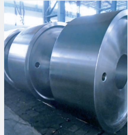
Fertig bearbeitete Laufrollenkörper
