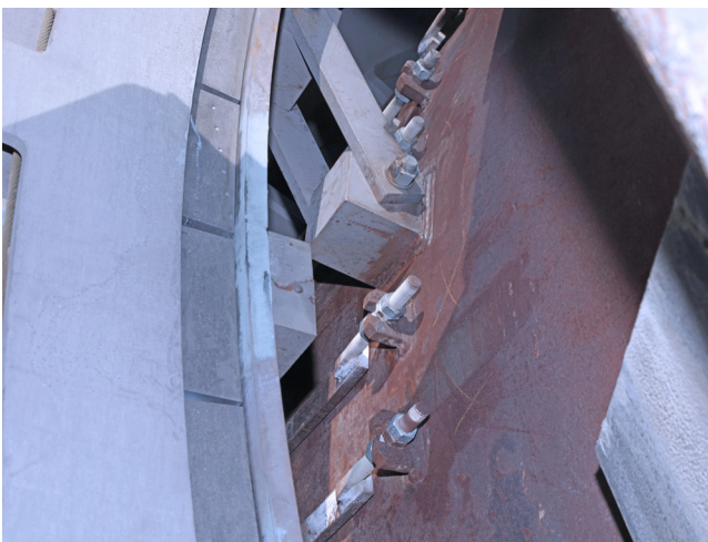
Das Anlenkerprinzip der Auslaufseite vereinfacht die Montage an deformierten herstellerübergreifenden Öfen.
