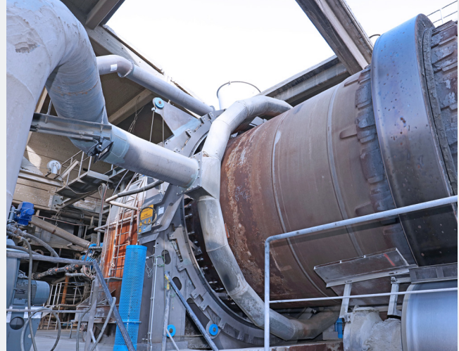
Graphitblockdichtung am Drehofen an der Auslaufseite.
