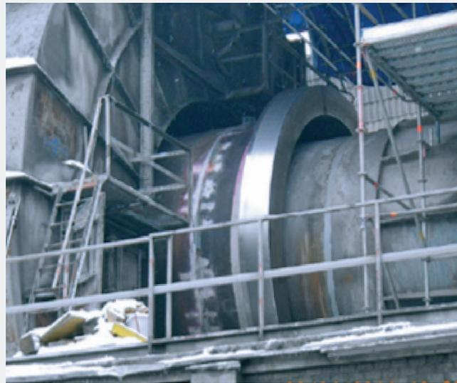
Station IV eines Drehofens mit Planetenkühler
